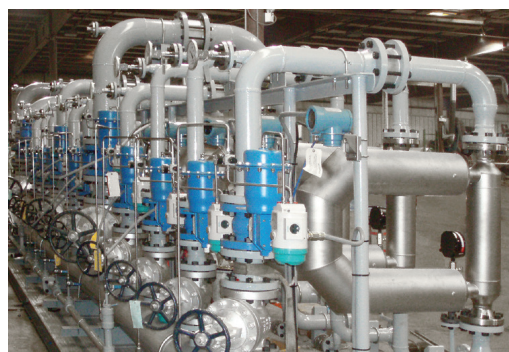
Поточные смесители топлива для смешения бензинов на НПЗ.
