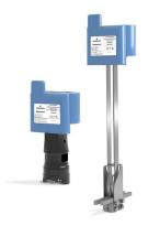
Беспроводные датчики коррозии обеспечивают прямое измерение толщины стенки. Система мониторинга проста в монтаже и обслуживании благодаря неинтрузивному принципу работы и беспроводной передаче данных. Система мониторинга коррозии и эрозии предоставляет данные для принятия более точных и своевременных решений. Датчики могут работать с любым металлом при температурах поверхности до 600 °C.
