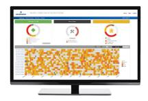
Программные приложения для мониторинга коррозии и эрозии являются частью цифровой экосистемы Plantweb™ от Эмерсон. Эти приложения преобразуют полученные с датчиков результаты измерений в полезную информацию, которая затем используется для визуализации и анализа.
