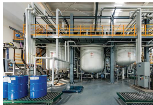
Для смешения небольших партий смазок используется два порционных смесителя объемом 10 тонн и один - 5 тонн.
