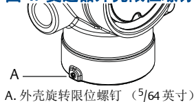
图 4. 变送器外壳限位螺钉
