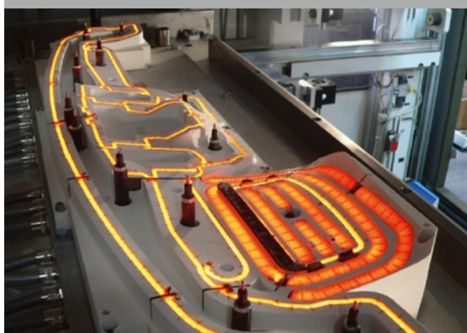
CITはインストルメントクラスターのハウジングやダッシュボードの裏にあるHVACダクトなどの大型パーツも溶着することができます。
