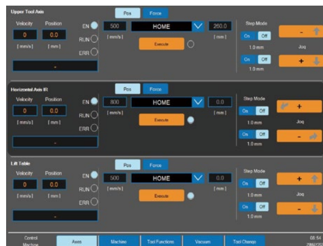
サーボ駆動リフトテーブルのパラメーター設定画面
