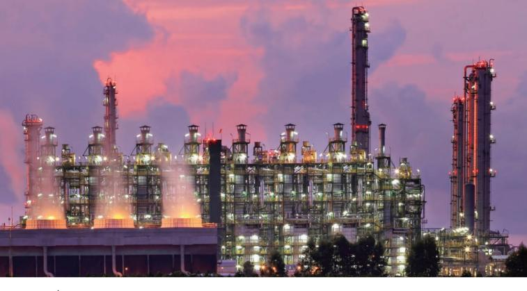
IT DOESN'T TAKE MUCH HEAT EXCHANGER SCALE TO CAUSE FUEL USAGE TO SKYROCKET – A QUARTER-INCH OF SCALE INCREASES FUEL USE AS MUCH AS 15%.
