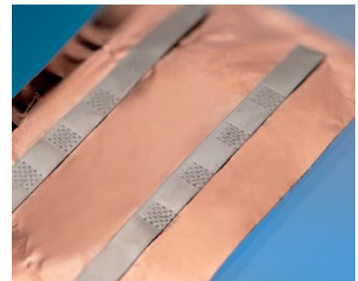
Small battery: Ni tab + Cu foil
