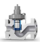
Zahlreiche Kanäle teilen den großen turbulenten Medienstrom in mehrere kleine, separate Strahlen auf, um die Geräuschbildung zu mindern
