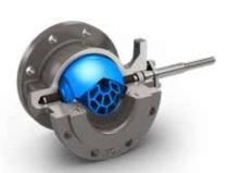
Mit einem geräuschmindernden Einsatz, der an die Rückseite der V-Schlitz-Kugel angeschweißt ist und den Durchfluss in mehrere kleinere Strahlen aufteilt
