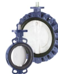
Os furos de localização do corpo facilitam a instalação e centralização entre os flanges. Borda em forma de disco redondo polida proporciona uma vedação total concêntrica, maior vida útil e estanqueidade à prova de bolhas. Não há necessidade de juntas de flange. Sem necessidade de remover o atuador durante a substituição do assento, a válvula de borboleta é adequada para a indústria de bebidas alcoólicas.
