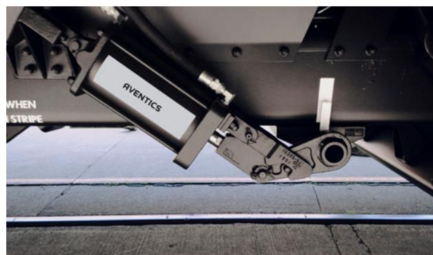
Vérin composite assurant l'ouverture et la fermeture des trappes de fond.
