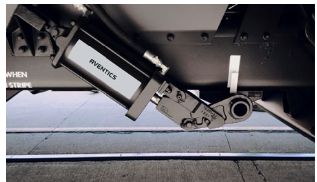
GFK-Zylinder zum Öffnen und Schließen der Bodenklappen.
