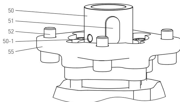
Vorbereitet für Drehantrieb entspr. DIN EN ISO 5210
