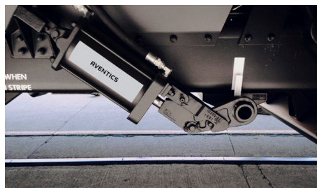
Cilindros de GFK para abrir y cerrar trampillas inferiores.
