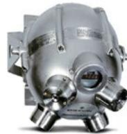
El Incus de Emerson es un avanzado sistema de detección de fugas de gas por ultrasonidos que utiliza cuatro sensores acústicos ultrasensibles que vigilan constantemente amplias zonas en busca de ultrasonidos generados por la fuga de gas presurizado. Ideal para vigilar entornos exteriores bien ventilados.
