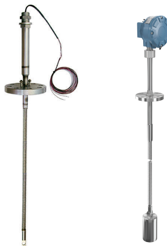
Figura 6.2: Izquierda - Sensor de temperatura multipunto con elementos Pt100 y funda metálica resistente a la corrosión. Derecha - Conjunto completo de medición de temperatura con transmisor, sensor, sensor opcional de nivel de agua y contrapeso.
