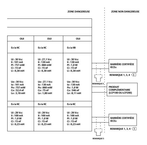
Figure 3. Schémas de boucle – FIELDVUE DVC6200f et DVC6200p
