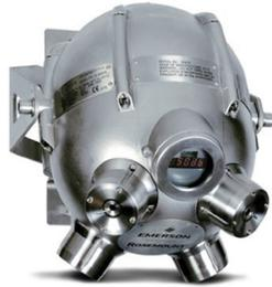
가압 가스 방출로 생성되는 초음파 영역을 지속적으로 모니터링 하는 4개의 고감도 음향 센서를 활용하는 가스 누설 검출 방식으로 수소 설비 및 사람의 안전을 보호합니다.
