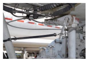
THE CABLE SHOULD BE AT A RIGHT ANGLE TO THE OPERATING LEVER AT THE MID-TRAVEL POSITION.
