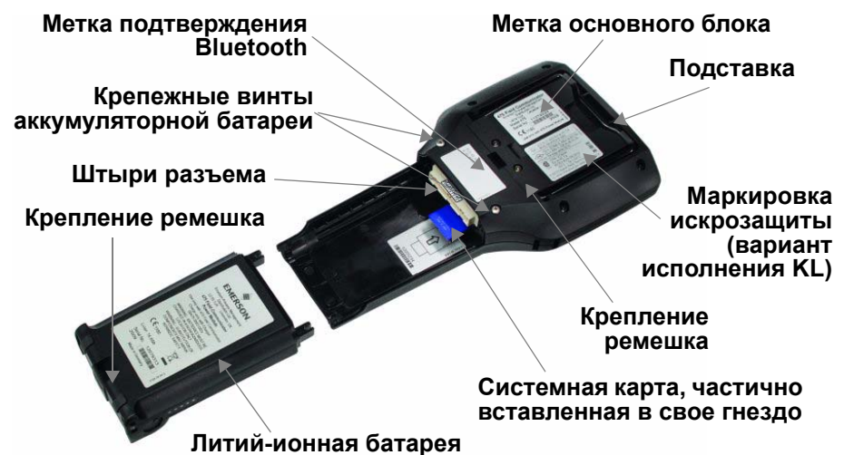
Рис. 2-6. Задняя панель полевого коммуникатора модели 475
