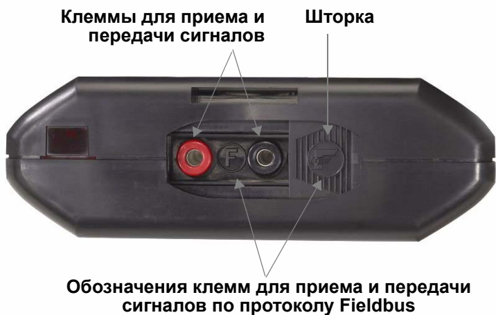
Рис. 4-2. Клеммы для приема и передачи сигналов по протоколу Fieldbus и шторка
