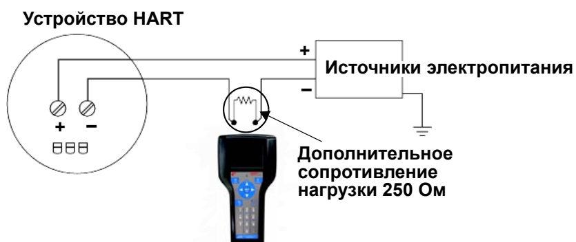
Рис. 3-5. Подключение с резистором 250 Ом
