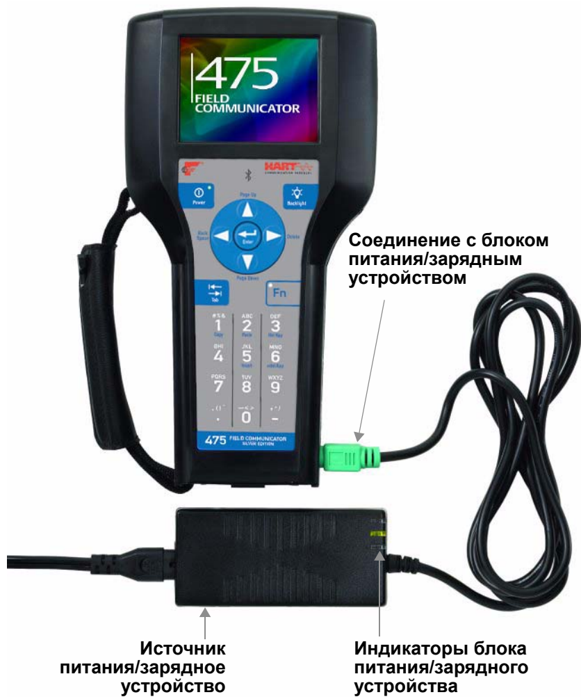
Рис. 2-2. Зарядка батареи, подключенной к полевому коммуникатору модели 475
