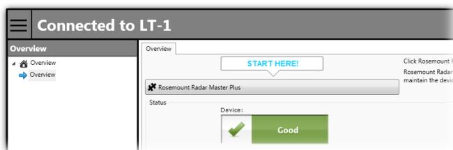
4. В *Configure* (Конфигурация) выберите **Guided Setup** (Пошаговая настройка) и следуйте указаниям на экране.
