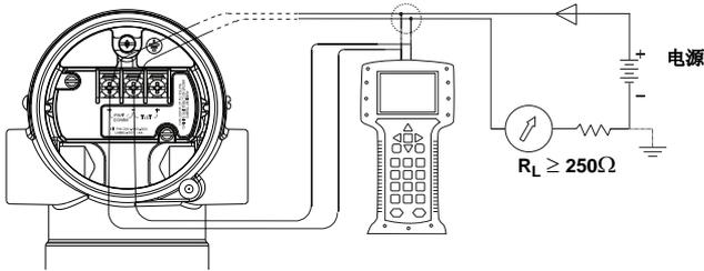
图 6. 1-5 Vdc 低功耗输出连线图
