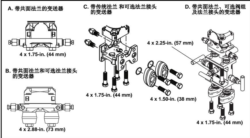
螺栓为典型的碳钢或者不锈钢。参考图 2 查看螺栓顶部的标志来确认材料类型。如果没有按照图 2 所示看到螺栓材料，请联系艾默生过程管理当地的办事处来了解更多信息。
