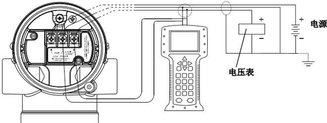
耐瞬变电压保护端子块的安装必须可靠接地, 否则不能提供保护功能。
