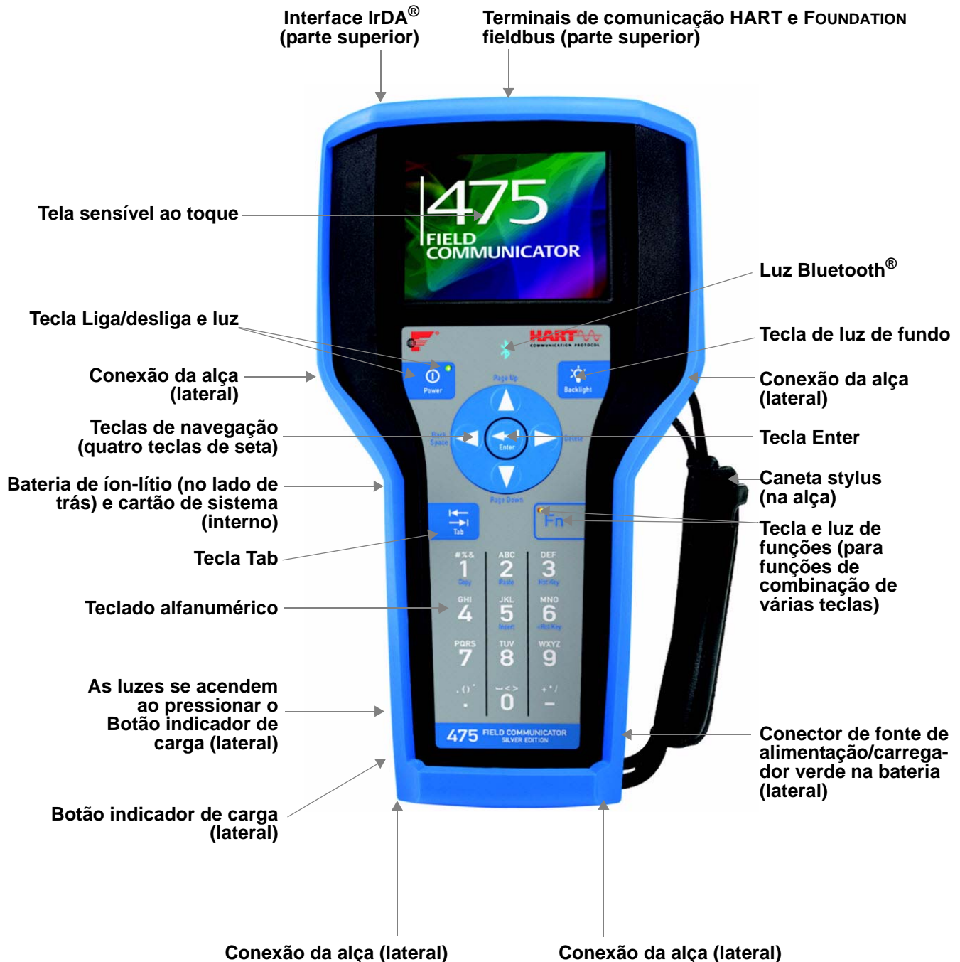
Figura 2-3. O comunicador de campo 475 mostrado com capa de borracha opcional.
