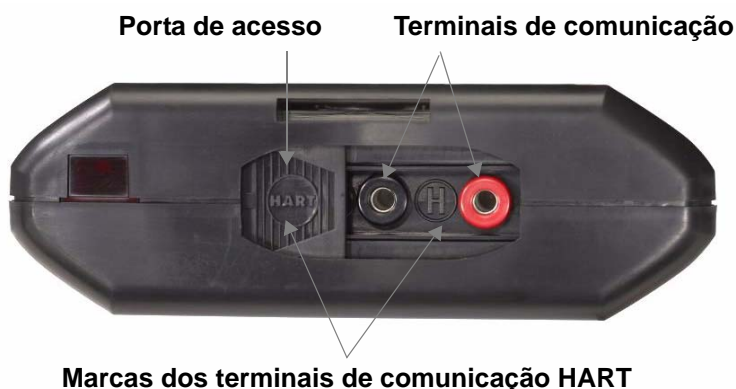
Figura 3-2. Terminais de comunicação e porta de acesso HART
