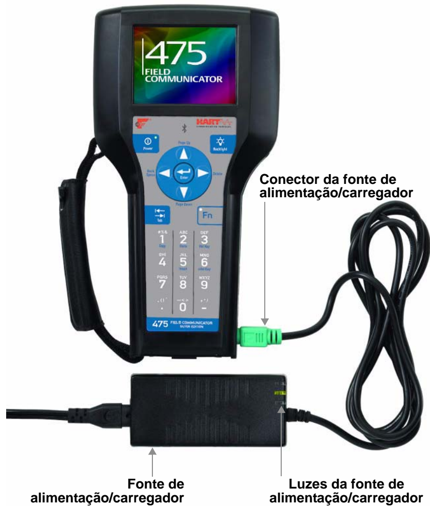
Figura 2-2. Como carregar a bateria conectada ao comunicador de campo 475
