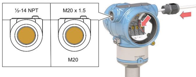
5. 连接电缆导线。
