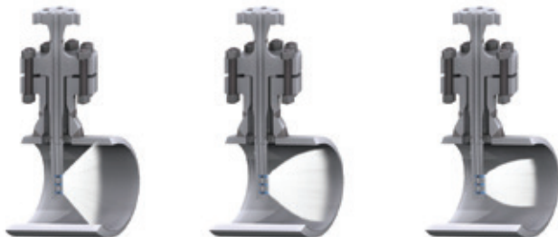
Figure 7.3 Pénétration du jet du désurchauffeur
