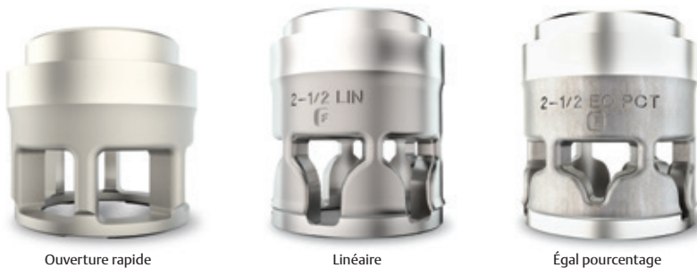
Figure 3.33 Cages caractérisées pour les corps de vannes droites
