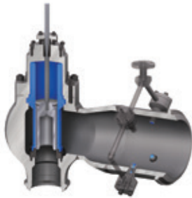
Figure 7.10 Vue de la section transversale d'une vanne de conditionnement de la vapeur
