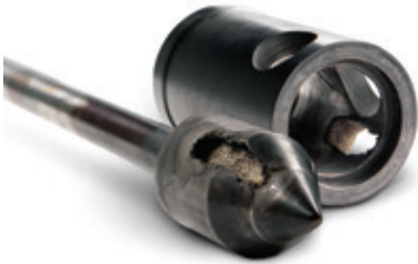
Figure 5.9 Aspect type des dommages de la cavitation
