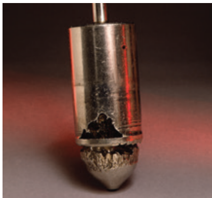
Figure 5.8 Aspect type des dommages de la détente
