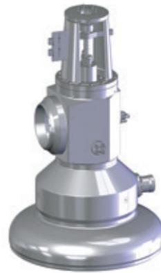
低压汽轮机旁路阀提供可靠的蒸汽减温减压以保护冷凝器。多级钻孔型阀塞最大化了低负荷工况下的流量。采用可选配连接接口，我们可以扩大阀门的出口，同时保持紧凑的设计。
