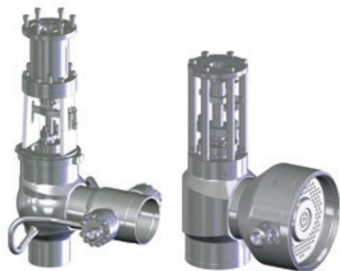
具有安全功能的蒸汽控制阀，在汽轮机和锅炉启停期间，调节蒸汽流量和温度。保护下游管道免受热冲击。
