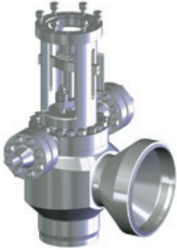
蒸汽控制阀，用于保护再热器冷段系统，特别是汽轮机发生跳闸事件时保护再热器和冷凝器。在汽轮机启动或关闭期间，调节蒸汽流量和温度。
