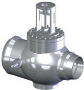
蒸汽调节阀带有内置的蒸汽辅助雾化喷嘴，可在低压条件下冷却过热蒸汽，并在发生汽轮机跳闸时保护冷凝器。在汽轮机启停时，调节蒸汽流量和温度。
