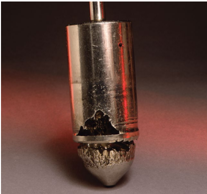
Abb. 5.8 Typisches Erscheinungsbild eines Schadens durch Flashverdampfung
