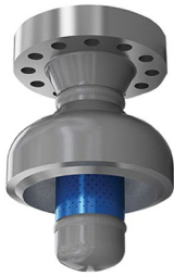
Abb. 7.13 Dampfzerstüber mit Geräuschminderung durch gebohrte Löcher
