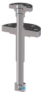
Abb. 7.4 Düsenanordnung mit fester Geometrie
