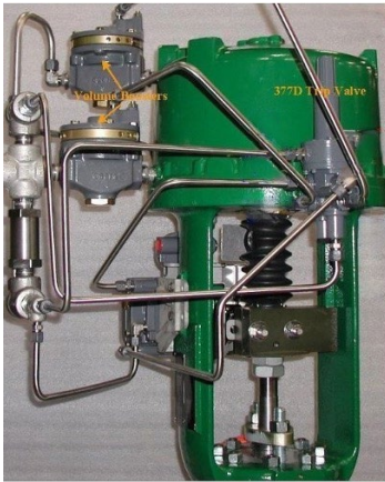
Abb. 4.8 Typische Booster-Installation mit einem doppelwirkenden Stellantrieb
