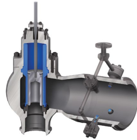
Abb. 7.10 Querschnittsdarstellung eines Dampfaufbereitungsventils
