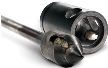
Abb. 5.9 Typisches Erscheinungsbild eines Schadens durch Kavitation
