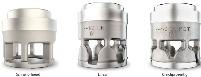
Abb. 3.37 Kennlinien-Käfige für Durchgangventil
