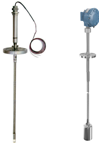
Figura 6.2: A sinistra - Sensore di temperatura multispot con elementi Pt100 e guaina metallica resistente alla corrosione. A destra - Gruppo completo di misura della temperatura con trasmettitore, sensore, sensore opzionale del livello dell'acqua e peso di ancoraggio.
