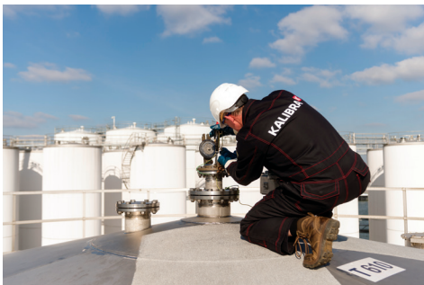
Figura 2.2: Misurazione manuale con un nastro per immersione.
